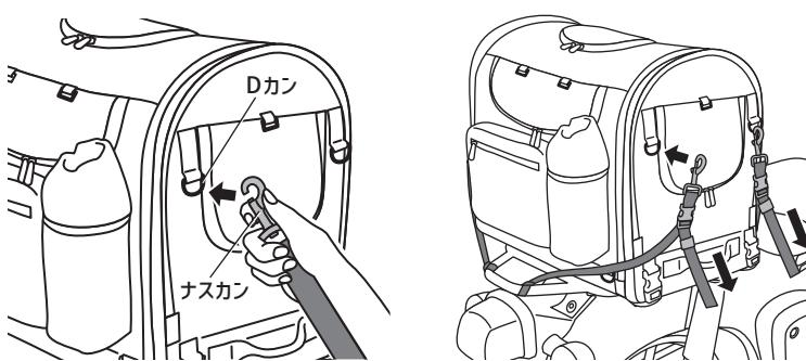
Dカンにベルト②のナスカンを取り付け、ベルトをしっかりと締めます。
